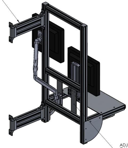
ADJUSTABLE MONITOR POSITION CAN BE MOUNTED ON LEFT OR RIGHT SIDE
